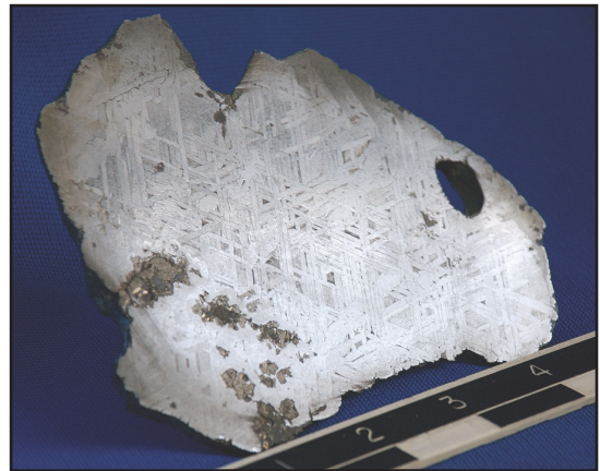
Figura 5: sección pulida de un meteorito de hierro-níquel, que muestra el patrón Widmanstätten.
